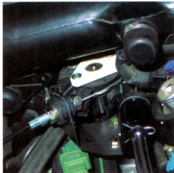
→ شکل ۱۶- براکت کابل عملگر و کوپلینگ تراتل
