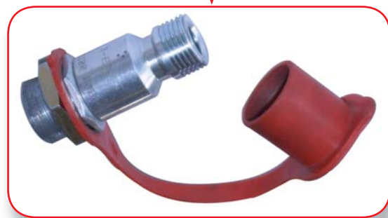
نمای شیر سوخت گیری وانت نیسان گازسوز
