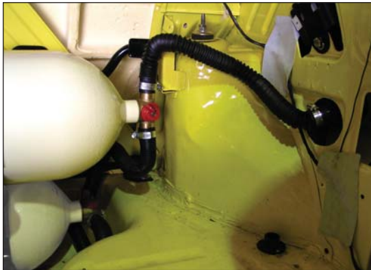
شیر سماوری و فیوز حساس به فشار
